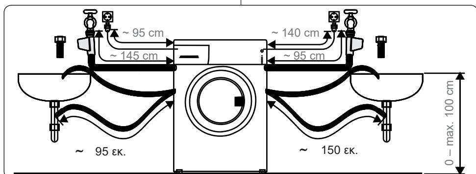
εύκαμπτου σωλήνα εισόδου νερού στη λευκή βαλβίδα εισόδου νερού στην πίσω πλευρά της συσκευής και το άκρο εύκαμπτου σωλήνα με κόκκινο πώμα στην κόκκινη βαλβίδα εισόδου νερού (αν έχει εφαρμογή).
