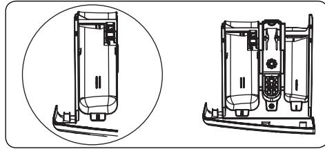
Αυτό το διαμέρισμα είναι για απορρυπαντικό σε υγρή μορφή ή σε σκόνη ή για υλικό αφαίρεσης αλάτων. Η πλάκα στάθμης υγρού απορρυπαντικού θα παρέχεται μέσα στη συσκευή σας.
