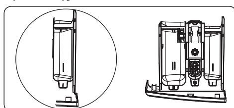
Αυτό το διαμέρισμα πρέπει να χρησιμοποιείται μόνον όταν έχει επιλεγεί η λειτουργία πρόπλυσης. Συνιστούμε να χρησιμοποιείτε τη λειτουργία πρόπλυσης
