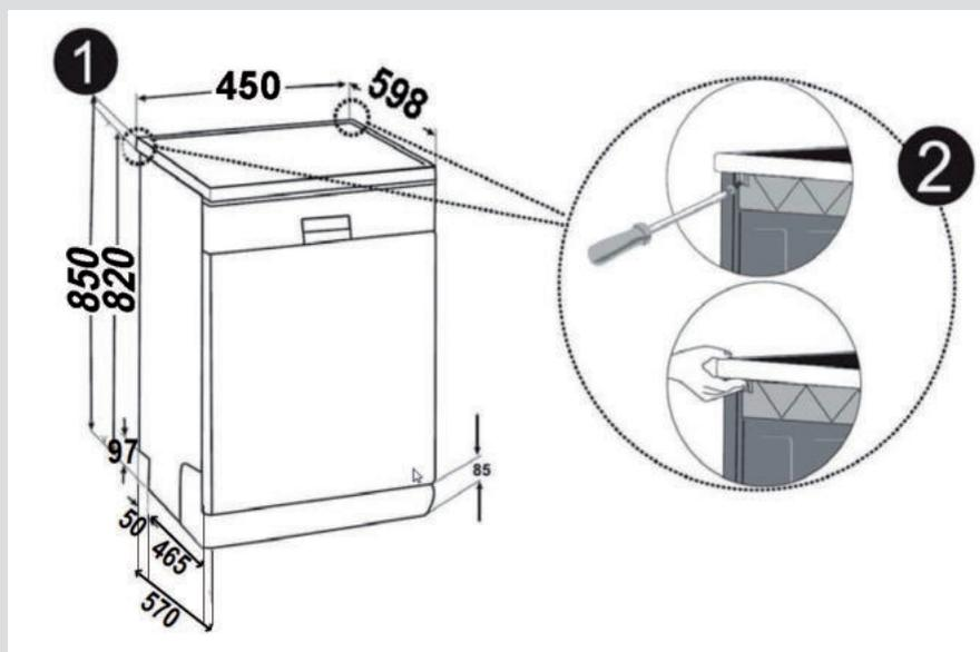
**Avertissement :** L'endroit où est installé le lave-vaisselle sans son top doit être stable afin d'éviter tout déséquilibre. Retirez le top du lave-vaisselle en dévissant les vis de fixation situées à l'arrière de l'appareil. Poussez ensuite le top de 1 cm de l'avant vers l'arrière et soulevez-le.
