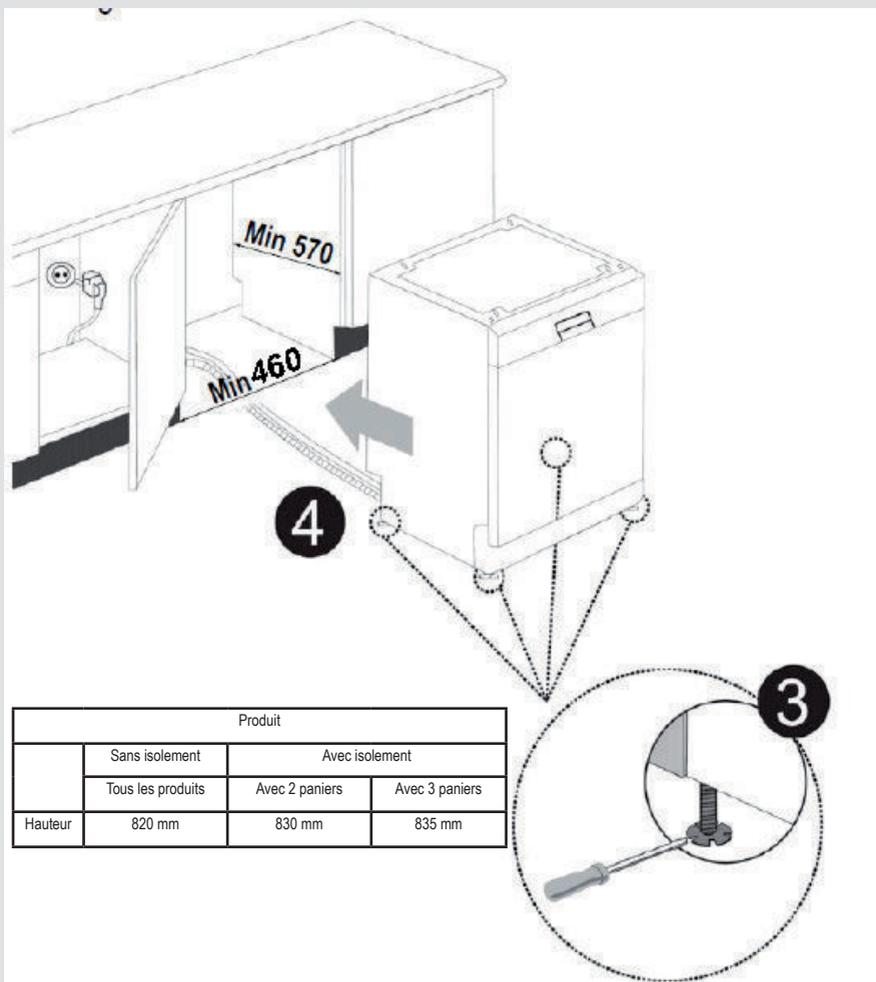
**Avertissement:** Une fois le top retiré, le lave-vaisselle doit être placé dans un endroit fermé dont les dimensions sont indiquées (Voir tableau ci-dessus)
