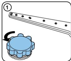
Pour ajouter du sel régénérant, ouvrez le couvercle du réservoir de sel en le tournant dans le sens anti-horaire (1) (2). À la première utilisation, mettez 1 kg de sel et de l'eau (3) dans le réservoir, jusqu'à ce qu'il déborde presque. Si possible, utilisez l'entonnoir (4) pour un remplissage plus facile. Remplacez le couvercle et fermez-le. Après tous les 20 à 30 cycles, ajoutez du sel dans votre appareil jusqu'à en faire le plein (environ 1 kg).
