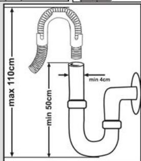
Vous pouvez raccorder le tuyau de vidange, soit directement à une vidange fixe, soit au raccord spécial sous l'évier. Au moyen d'un tuyau coudé spécial (si disponible), vous pouvez vidanger le lave-vaisselle directement dans l'évier en accrochant le tuyau coudé au bord de l'évier. Assurez-vous que le raccordement est effectué à au moins 50 cm et au plus à 110 cm du niveau du sol.
