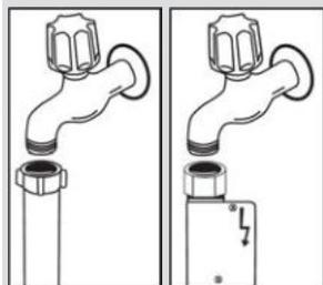
Une fois le raccordement effectué, ouvrez le robinet à fond et vérifiez l'étanchéité. Pour la sécurité de votre lave-vaisselle, veuillez toujours fermer le robinet d'arrivée d'eau après la fin de chaque programme de lavage.
