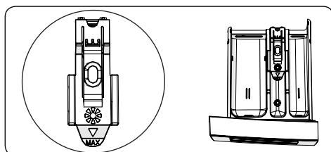
Detta fack är för mjukgörare, balsam och stärkelse. Följ anvisningarna på förpackningen. Om mjukgörare lämnar rester efter användning, prova att späda ut dem eller använda en flytande mjukgörare.
