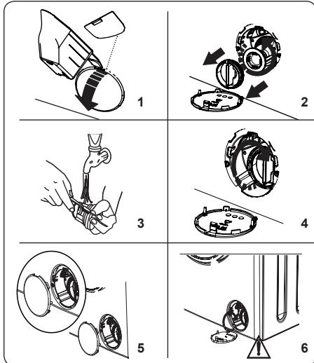
Pumpefilteranlegget i vaskemaskinen forlenger pumpens levetid ved å forhindre at lo kommer inn i maskinen.
