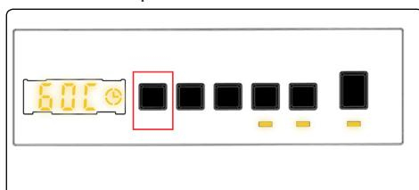
När du väljer ett program väljs maximal temperatur för det programmet automatiskt. För att justera temperaturen, tryck på vattentemperaturjusteringsknappen tills önskad temperatur visas på den digitala displayen.
