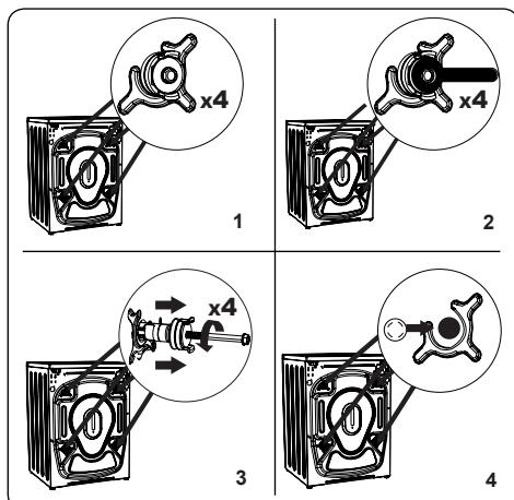
1. Innan du använder tvättmaskinen, ta bort de 4 transportbultarna och gummidistanserna från baksidan av maskinen. Om bultarna inte tas bort kan de orsaka kraftig vibration, buller och fel på maskinen och orsaka att garantin ogiltigförklaras.
