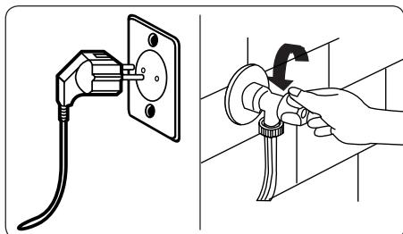
Slå av strømforsyningen og ta støpselet ut av stikkontakten før du utfører vedlikehold og rengjøring av maskinen.
