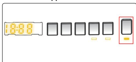
Genom att trycka på Start / Paus-knappen kan du starta programmet som du har valt eller avbryta ett pågående program. Om du växlar maskinen till vänteläge, böjar Start/Paus-lysdioden på den elektroniska displayen att blinka.
