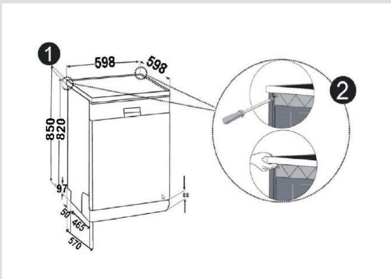
**Avertissement :** L'endroit où est installé le lave-vaisselle sans son top doit être stable afin d'éviter tout déséquilibre. Retirez le top du lave-vaisselle en dévissant les vis de fixation situées à l'arrière de l'appareil. Poussez ensuite le top de 1 cm de l'avant vers l'arrière et soulevez-le.
