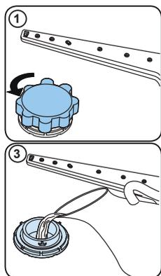
Pour ajouter du sel régénérant, ouvrez le couvercle du réservoir de sel en le tournant dans le sens anti-horaire. (1) À la première utilisation, mettez 1 kg de sel et de l'eau (2) dans le réservoir jusqu'à ce qu'il déborde presque. Si possible, utilisez l'entonnoir (4) pour un remplissage plus facile. Remplacez le couvercle et fermez-le. Après tous les 20 à 30 cycles, ajoutez du sel dans votre appareil jusqu'à en faire le plein (environ 1 kg).
