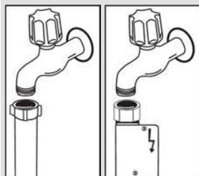
**NB :** Certains modèles utilisent un système Aquastop. Si votre lave-vaisselle est équipé de la fonction Aquastop, il y a du courant avec une tension dangereuse. Ne coupez pas l'embout Aquastop. Veillez aussi à ce qu'il ne soit pas plié ou tordu.
