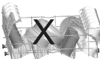
Η λανθασμένη φόρτωση μπορεί να έχει σαν αποτέλεσμα κακή απόδοση τηλυσίματος και στεγνώματος. Τηρείτε τις υποδείξεις του κατασκευαστή για να έχετε τα καλύτερα αποτελέσματα
