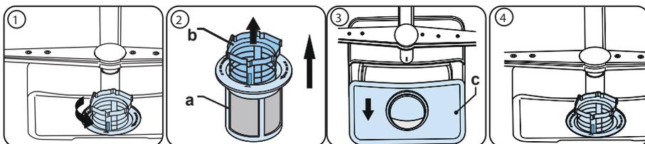
Para extraer y limpiar el conjunto de filtros, gírelo en sentido contrario a las agujas del reloj y extráigalo levantándolo hacia arriba **(1)**. Saque el filtro grueso del filtro micro **(2)**. Luego saque y retire el filtro metálico **(3)**. Aclare el filtro con abundante agua hasta que quede libre de residuos. Vuelva a montar los filtros. Coloque de nuevo el conjunto de filtros y gírelo en el sentido de las agujas del reloj. **(4)**.
