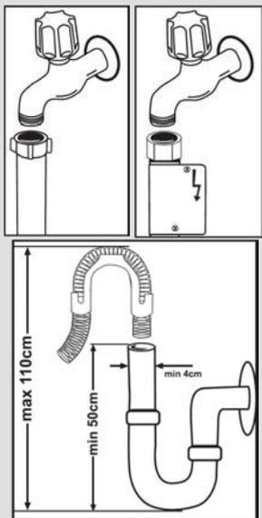
**NOTA:** En algunos modelos se utiliza una toma de agua Aquastop. En el caso de estar utilizando un Aquastop, existe una tensión peligrosa. No corte la toma Aquastop. No deje que se doble o retuerza.
