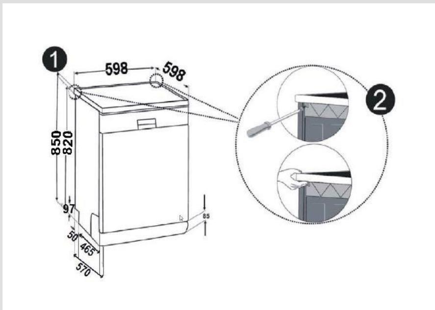
**Advertencia:** La pieza del soporte que se colocará bajo la máquina, mediante la extracción de la encimera, debe ser estable de modo que no se produzcan alteraciones del equilibrio.
