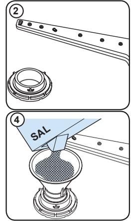
ablandador de sal del aparato es suficiente o no, compruebe la parte transparente de la tapa del compartimento de sal. Hay sal suficiente si la parte transparente está verde. Tiene que añadir sal si no está verde.
