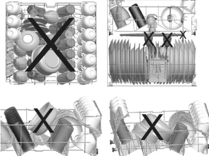
Una carga incorrecta puede causar un rendimiento deficiente en el lavado y el secado. Por favor, siga las recomendaciones del fabricante para obtener un buen resultado.
