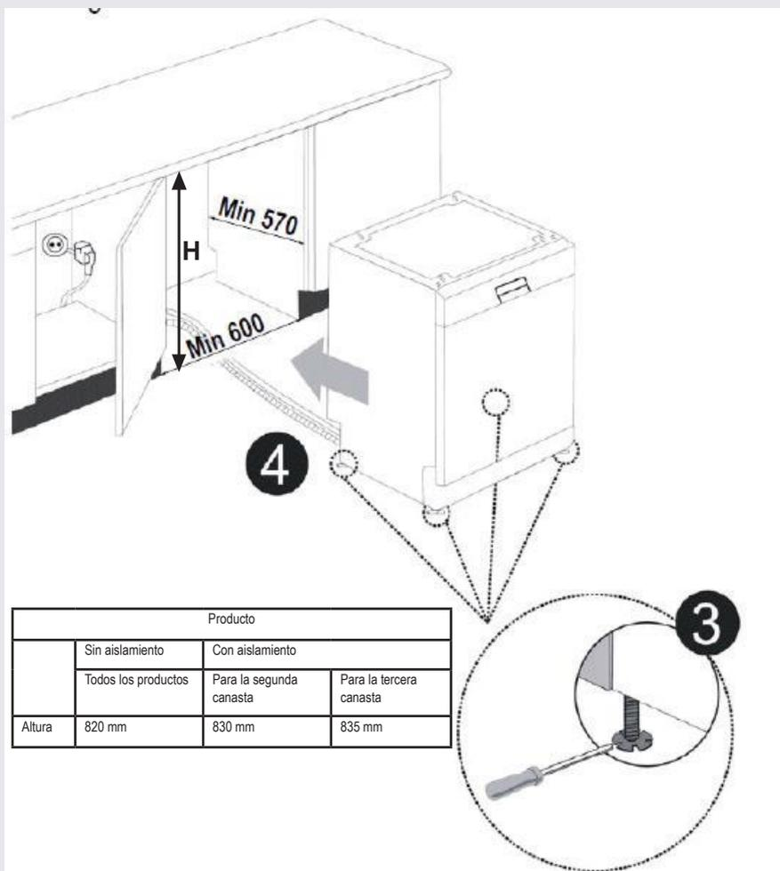
**Advertencia:** Después de sacar la tapa, la máquina debe ser colocada en un espacio cerrado de las dimensiones mostradas en la fig.
