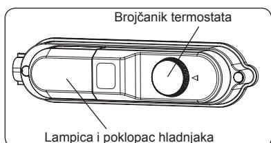
Termostat automatski ugađa temperaturu u hladnjaku. Postavljanjem gumba termostata od položaja 1 do položaja 5, u hladnjaku se snizuje temperatura hlađenja.
