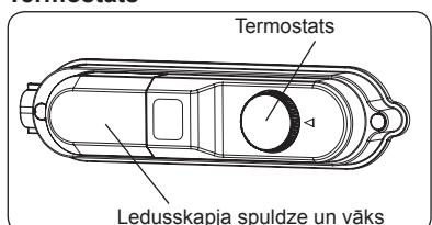
Termostats automātiski regulē ledusskapja nodalījumu temperatūru. Pagriežot regulatoru no 1. uz 5. stāvokli, temperatūra būs zemāka.
