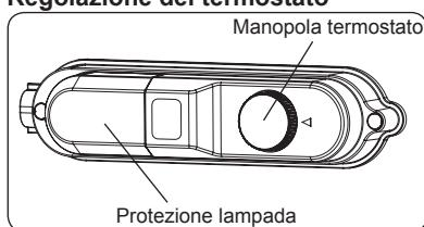
Il termostato regola automaticamente la temperatura all'interno degli scomparti frigorifero. È possibile ottenere temperature inferiori ruotando la manopola su valori più alti, in una scala da 1 a 5.
