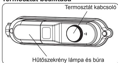
A termosztát automatikusan szabályozza a belső hőmérsékletet a hűtő részben egyaránt. A forgatható gomb minimumtól maximumig (1-5) való állításával egyre hidegebb hőmérséklet érhető el. A hűtőszekrénynek nincs fagyaszórekesze, de 4 - 6 °C-ig képes hüteni.
