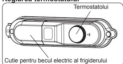
Funcția termostatului este de a regla automat temperatura din interiorul frigiderului și. Prin rotirea butonului între pozițiile 1 – 5 se obțin temperaturi din ce în ce mai scăzute.
