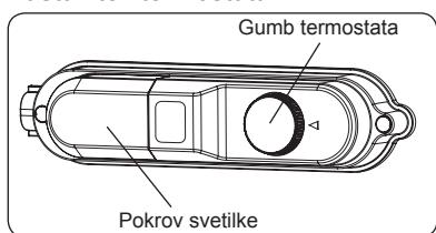
Termostat samodejno uravnava temperaturo v hladilniku. Z vrtenjem gumba do položaja 1 proti 5 se temperatura niža.
