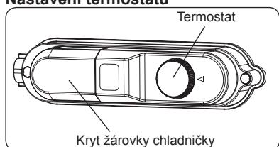
Termostat automaticky reguluje vnitřní teplotu chladničky. Otocením knoflíku z polohy "1" k "5" lze nastavit nižší teploty.
