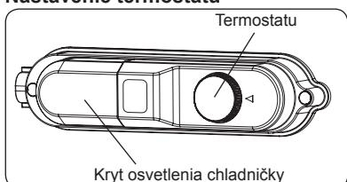
Termostat automaticky reguluje vnútornú teplotu chladiaceho oddelenia. Pri otáčaní gombíkom od pozície «1» do «5» možno dosiahnuť nižšiu teplotu.
