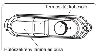
A termosztát automatikusan szabályozza a belső hőmérsékletet a hűtő részben egyaránt. A forgatható gomb minimumtól maximumig (1-5) való állításával egyre hidegebb hőmérséklet érhető el.
