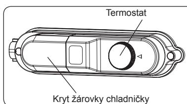
Termostat automaticky reguluje vnitřní teplotu chladničky. Otocením knoflíku z polohy "1" k "5" lze nastavit nižší teploty.
