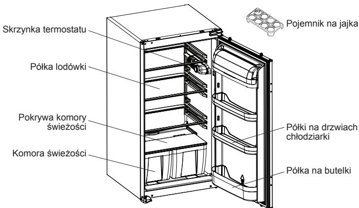
Zamieszczony w celach informacyjnych rysunek przedstawia różne części i elementy wyposażenia. Części mogą różnić się w zależności od modelu urządzenia.
