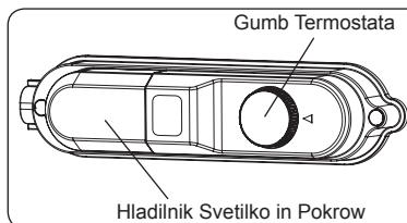
Termostat samodejno uravnava temperaturo v hladilniku. Z vrtenjem gumba od položaja 1 proti 5 se temperatura niža.
