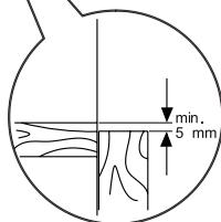
Sett ovnen inn i skapet ved å skyve den forover. Åpne ovnsdøren og sett inn 2 skruer i hullene på ovnens ramme. Når produktets ramme berører skapets treverk, skrur du til skruene.
