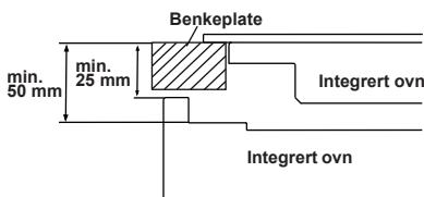
Hvis ovnen skal installeres under en kokeplate, må avstanden mellom benkeplaten og den øvre delen av ovnen være minst 50 mm, og avstanden mellom benkeplaten og toppen av kontrollpanelet må være minst 25 mm.
