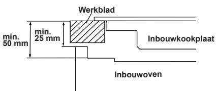
Als de oven wordt geplaatst onder een kookplaat, dient de afstand tussen het werkblad en het bovenpaneel van de oven minimaal 50 mm en de afstand tussen het werkblad en de bovenkant van het bedieningspaneel minimaal 25 mm te bedragen.
