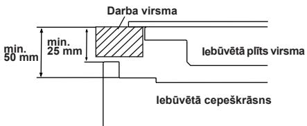
Ja cepeškrāsns tiek uzstādīta zem plīts virsmas, attālumam no darba virsmas līdz cepeškrāsns augšpusei ir jābūt vismaz 50 mm un attālumam no darba virsmas līdz vadības paneļa virspusei ir jābūt vismaz 25 mm.
