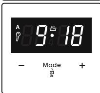
Lorsque la minuterie arrive à zéro, le four s'arrête et un signal sonore résonne. L'icône « **A** » clignote. Placez les deux boutons de commande sur « **0** » et appuyez sur n'importe quelle touche de la minuterie pour arrêter le signal sonore. Appuyez sur « **MODE** » pendant 2 secondes et l'icône « **A** » disparaît et la minuterie repasse au fonctionnement manuel.
