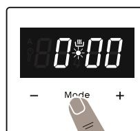
1. Appuyez sur « MODE » pendant 2 secondes pour désactiver le verrouillage des touches et le point au milieu de l'écran se mettra à clignoter.
