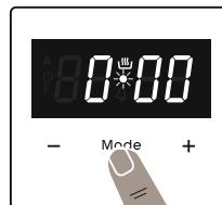
1. Pritisnite „MODE“ 2 sekunde za deaktiviranje zaključavanja tipki i točka u središtu zaslona će zatreptati.
