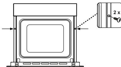
Pećnicu umetnite u kuhinjski ormarić tako da ju gurate prema naprijed. Otvorite vrata pećnice i umetnите 2 vijka u otvore koji se nalaze na okviru pećnice. Kad okvir proizvoda dodirne drvenu površinu ormarića, zategnjite vijke.
