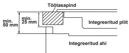
Kui ahi paigaldatakse pliidiplaadi alla, peab tööpinna ja ahju pealmispaneeli vaheline jääma vähemalt 50 mm ning tööpinna ja juhtpaneeli pealispinna vaheline vähemalt 25 mm vaba ruumi.
