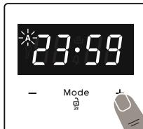
5. Odaberite željeno vrijeme završetka korištenjem tipki „+“ i „-“. Simbol „“ će nestati. Dodajte razdoblje kuhanja trenutačnom dnevnom vremenu. Nakon ovoga vrijeme možete postaviti do 23 sati i 59 minuta.
