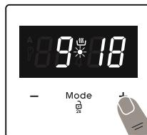
2. Postavite vrijeme dok točka trepće korištenjem tipki „+“ i „-“.
