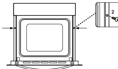
Inserire il forno nella cabina spingendo-lo in avanti. Aprire lo sportello del forno e inserire due viti nei fori ubicati sopra il telaio del forno. Quando il telaio del prodotto tocca la superficie in legno del cabinato, serrare le viti.
