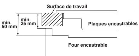
Si le four est installé sous une plaque de cuisson, la distance entre la surface de travail et le panneau supérieur du four doit être au moins 50 mm et la distance entre la surface de travail et la surface supérieure du panneau de contrôle doit être au moins 25 mm.
