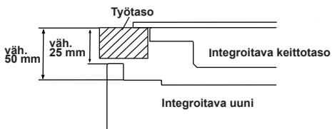
Jos uuni asennetaan lieden sisälle, työpöydän ja uunin yläpaneelin välissä on oltava vähintään 50 mm, ja etäisyyden työtason ja ohjauspaneelin yläosan välinä tulee olla vähintään 25 mm.
