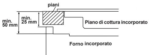
Se il forno è installato sotto un piano di cottura, la distanza tra il piano e il pannello superiore del forno deve essere almeno di 50 mm e la distanza tra il piano e la parte superiore del pannello di controllo deve essere almeno di 25 mm.
