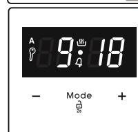
Kun ajastimen aika on kulunut loppuun, uuni kytkeytyy pois päältä ja kuuluu varoitusääni. Symboli "A" vilkkuu. Sammuta varoitusääni käänämällä molemmat säätimet asentoon "0" ja painamalla mitä tahansa ajastimen näppäintä.
