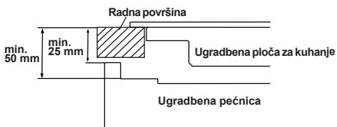
Ako pećnicu ugrađujete ispod ploče za kuhanje, razmak između radne površine i gornjeg dijela ploče pećnice mora biti minimalno 50 mm, a razmak između radne površine i gornjeg dijela upravljačke ploče mora biti minimalno 25 mm.
