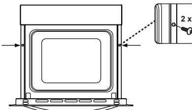
Insérez le four dans son emplacement en le poussant vers l'avant. Ouvrez la porte du four et insérez deux vis dans les trous situés sur le cadre du four. Lorsque le cadre du four touche la surface en bois du compartiment, serrez les vis.
