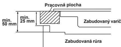
Ak rúru inštalujete pod varič, vzdialenosť medzi pracovným povrchom a horným panelom rúry musí byť minimálne 50 mm a vzdialenosť medzi pracovným povrchom a vrchom ovládacieho panela musí byť minimálne 25 mm.
