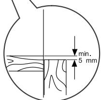
Inserire il forno nella cabina spingendo lo in avanti. Aprire lo sportello del forno e inserire due viti nei fori ubicati sopra il telaio del forno. Quando il telaio del prodotto tocca la superficie in legno del cabinato, serrare le viti.
