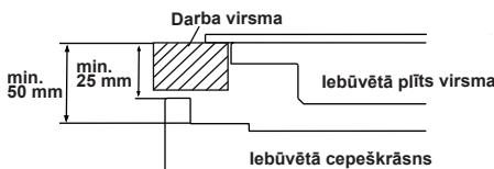
Ja cepeškrāsns tiek uzstādīta zem plīts virsmas, attālumam no darba virsmas līdz cepeškrāsns augšpusei ir jābūt vismaz 50 mm un attālumam no darba virsmas līdz vadības paneļa virspusei ir jābūt vismaz 25 mm.
