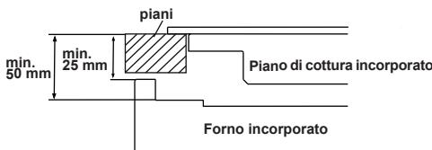
Se il forno è installato sotto un piano di cottura, la distanza tra il piano e il pannello superiore del forno deve essere almeno di 50 mm e la distanza tra il piano e la parte superiore del pannello di controllo deve essere almeno di 25 mm.
