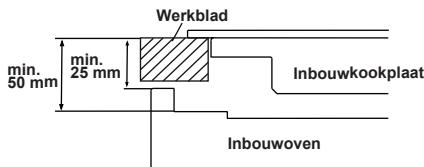
Als de oven wordt geplaatst onder een kookplaat, dient de afstand tussen het werkblad en het bovenpaneel van de oven minimaal 50 mm en de afstand tussen het werkblad en de bovenkant van het bedieningspaneel minimaal 25 mm te bedragen.
