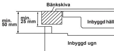
Om ugnen installeras under en häll, måste avståndet mellan bänkskivan och den övre panelen på ugnen vara minst 50 mm och avståndet mellan bänkskivan och toppen av kontrollpanelen måste vara minst 25 mm.
