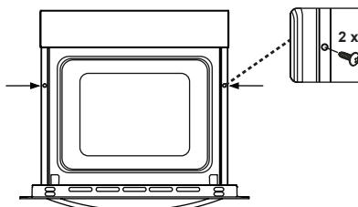
Sätt in ugnen i skåpet genom att skjuta den framåt. Öppna ugnsluckan och sätt i de 2 skruvarna i hålen på ugnens ram. När produktramen vidrör träytan på skåpet, dra åt skruvarna.
