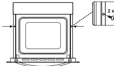
Plaats de oven in de kast door hem naar voren te duwen. Open de ovendeur en plaats 2 schroeven in de gaten op de ovenframe. Als de frame van het product het houten oppervlak van de kast raakt, schroef deze schroeven dan vast.
