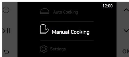
V menu manuálního vaření může koncový uživatel vybrat funkce vaření, délku trvání a čas ukončení vaření. Chcete-li změnit některé specifikace, možnostmi procházejte pomocí tlačítek NAHORU a DOLŮ a výběr potvrďte tlačítkem OK. Po klepnutí se vybraná specifikace rozbliká. Během blikání se ke změně hodnoty specifikace použijí tlačítka NAHORU a DOLŮ. Výběr můžete dokončit klepnutím na tlačítko OK.
