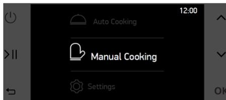
I den manuelle tilberedningsmenu kan tilberedningsfunktioner, temperatur, boost-funktion, varighed af tilberedning og sluttid for tilberedning indstilles af slutbrugeren. Bladr med op- og ned-knapperne for at ændre en specifikation, og vælg specifikationen med OK-knappen. Den valgte specifikation blinker, når du har trykket. Mens den blinker, kan op- og ned-knapperne bruges til at ændre specifikationens værdi. Du afslutter valget ved at trykke på OK-knappen.
