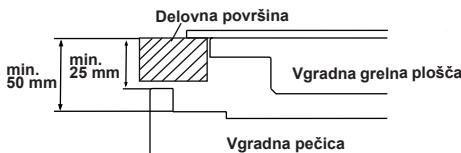
Če je pečica nameščena pod grelno ploščo, mora biti najmanjša razdalja med delovno površino in zgornjo ploščo pečice 50 mm in razdalja med delovno površino in vrhom upravljalne plošče najmanj 25 mm.
