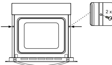
Introduceți cuptorul încorporat în dulap și țărișeți-l în față. Deschideți ușa cuptorului și introduceți două șuruburi în găurile amplasate în rama cuptorului. Strângeți șuruburile, când rama produsului atinge suprafața de lemn a dulapului.
