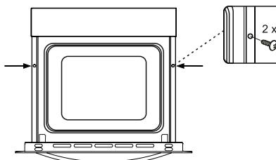
Pečico vstavite v ohišje tako, da jo potisnete naprej. Odprite vrata pečice in vstavite 2 vijaka v luknji na ogrodju pečice. Ko se ogrodje dotika lesene površine ohišja, zategnjte vijaka.
