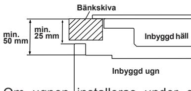
Om ugnen installeras under en häll, måste avståndet mellan bänkskivan och den övre panelen på ugnen vara minst 50 mm och avståndet mellan bänkskivan och toppen av kontrollpanelen måste vara minst 25 mm.
