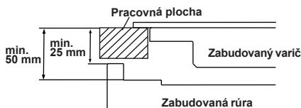
Ak rúru inštalujete pod varič, vzdialosť medzi pracovným povrchom a horným panelom rúry musí byť minimálne 50 mm a vzdialosť medzi pracovným povrchom a vrchom ovládacieho panela musí byť minimálne 25 mm.
