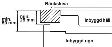
Om ugnen installeras under en häll, måste avståndet mellan bänkskivan och den övre panelen på ugnen vara minst 50 mm och avståndet mellan bänkskivan och toppen av kontrollpanelen måste vara minst 25 mm.
