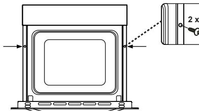
Pečico vstavite v ohišje tako, da jo potisnete naprej. Odprite vrata pečice in vstavite 2 vijaka v luknji na ogrodju pečice. Ko se ogrodje dotika lesene površine ohišja, zategnjite vijaka.
