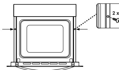
Sett ovnen inn i skapet ved å skyve den forover. Åpne ovnsdøren og sett inn 2 skruer i hullene på ovnens ramme. Når produktets ramme berører skapets treverk, skrur du til skruene.
