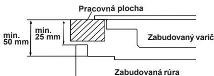
Ak rúru inštalujete pod varič, vzdialosť medzi pracovným povrchom a horným panelom rúry musí byť minimálne 50 mm a vzdialosť medzi pracovným povrchom a vrchom ovládacieho panela musí byť minimálne 25 mm.
