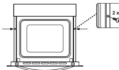
Introduceți cuptorul încorporat în dulap și împingeți-l în față. Deschideți ușa cuptorului și introduceți două șuruburi în găurile amplasate în rama cuptorului. Strângeți șuruburile, când rama produsului atinge suprafața de lemn a dulapului.
