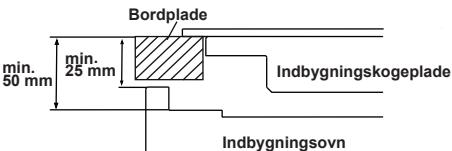
Hvis ovnen installeres under en kogelade, skal afstanden mellem bordplade og toppanelet på ovnen være mindst 50 mm, og afstanden mellem bordpladen og toppen af betjeningspanelet skal minimum være 25 mm.
