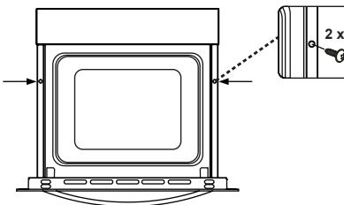
Insira o forno dentro do compartimento empurrando-o para a frente. Abra a porta do forno e insira 2 parafusos nos furos situados na armação do forno. Enquanto a armação do produto estiver tocar na superfície de madeira do compartimento, aperte os parafusos.
