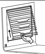
com armação de esmalte catalítica, as paredes traseira e laterais da armação interior não necessitam de ser limpas. No entanto, dependendo da utilização, recomenda-se que as substitua ao fim de um certo período de tempo.
