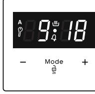
4. На екрані з'явиться поточний час і засвітяться символи “ $\ddot{\text{A}}$ ” та “ $\ddot{\text{Q}}$ ”.
