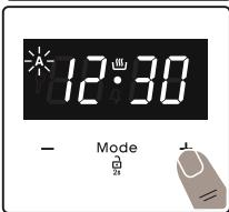
3. Använd knapparna "+" och "-" för att ställa in önskad sluttid.
