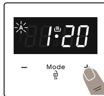
3. Välj önskad tillagningsperiod med hjälp av knapparna "+" och "-".
