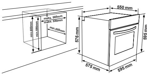
Ubacite rernu u ormarić tako što će je gurnuti napred. Otvorite vrata rerne i ubacite 2 šrafa u rupe koje su locirane na okviru rerne. Dok okvir proizvoda dodiruje drvenu površinu ormarića, zategnite šrafove.
