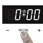
1. Затисніть кнопку "MODE" на 2 секунди задля вимкнення блокування кнопок поки не загориться крапка посередині екрану.
