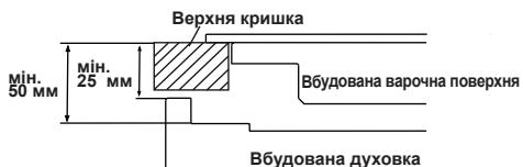
Якщо духовка встановлюється під варочною поверхнею, відстань від робочою поверхнею та духовкою має бути не менше ніж 50 мм, а між робочою поверхнею та верхом панелі керування — не менше ніж 25 мм.
