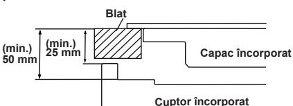
Dacă instalați cuptorul sub o poliță, distanța între blatul de lucru și panoul de sus al cuptorului trebuie să fie de minimum 50 de milimetri, iar distanța între blatul de lucru și partea superioară a panoului de control trebuie să fie de minimum 25 de milimetri.
