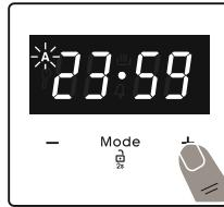
5. Välj önskad sluttid med hjälp av knapparna "+" och "-". " " -symbolen kommer att försvinna. Lägg till tillagningsperioden till den aktuella tiden på dagen. Du kan ställa in en tid på upp till 23 timmar och 59 minuter efter detta.
