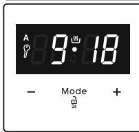
Коли на таймері буде нуль, духова шафа вимкнеться та пропунає звуковий сигнал. Заблимає символ “**A**”. Включіть обидві кнопки керування на положення “**0**” і натисніть будь-яку клавішу на таймері для того, щоб зупинити звуковий сигнал. Затисніть кнопку “**MODE**” протягом 2 секунд, зникне символ “**A**” і таймер повернеться знову в MODE самостійного налаштування.
