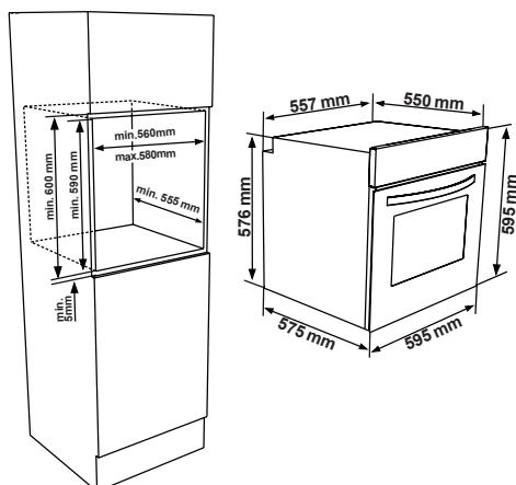
Ak rúru inštalujete pod varič, vzdialenosť medzi pracovným povrchom a horným panelom rúry musí byť minimálne 50 mm a vzdialenosť medzi pracovným povrchom a vrchom ovládacieho panela musí byť minimálne 25 mm.
