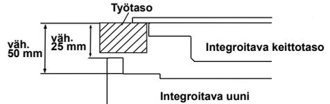
Jos uuni asennetaan liedon sisälle, työpöydän ja uunin yläpaneelin välissä on oltava vähintään 50 mm, ja etäisyyden työtason ja ohjauspaneelin yläosan välillä tulee olla vähintään 25 mm.
