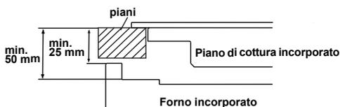
Se il forno è installato sotto un piano di cottura, la distanza tra il piano e il pannello superiore del forno deve essere almeno di 50 mm e la distanza tra il piano e la parte superiore del pannello di controllo deve essere almeno di 25 mm.
