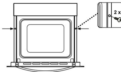
Insérez le four dans son emplacement en le poussant vers l'avant. Ouvrez la porte du four et insérez deux vis dans les trous situés sur le cadre du four. Lorsque le cadre du four touche la surface en bois du compartiment, serrez les vis.
