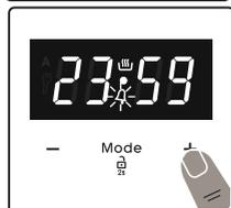
2. Odaberite željeno vremensko razdoblje korištenjem tipki „+“ i „-“ dok trepće „**A**“.
