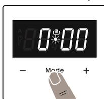
1. Premere "MODE" per 2 secondi per disattivare il blocco tasti e il punto al centro dello schermo inizierà a lampeggiare.
