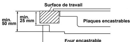
Si le four est installé sous une plaque de cuisson, la distance entre la surface de travail et le panneau supérieur du four doit être au moins 50 mm et la distance entre la surface de travail et la surface supérieure du panneau de contrôle doit être au moins 25 mm.
