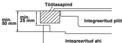
Kui ahi paigaldatakse pliidiplaadi alla, peab tööpinna ja ahju pealmispaneeli vahele jääma vähemalt 50 mm ning tööpinna ja juhtpaneeli pealispinna vahele vähemalt 25 mm vaba ruumi.
