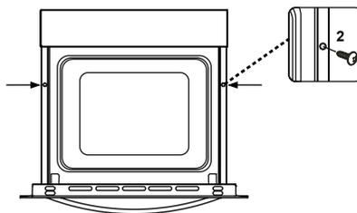
Inserire il forno nella cabina spingendolo in avanti. Aprire lo sportello del forno e inserire due viti nei fori ubicati sopra il telaio del forno. Quando il telaio del prodotto tocca la superficie in legno del cabinato, serrare le viti.
