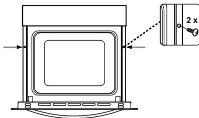
Pećnicu umetnete u kuhinjski ormarić tako da ju gurate prema naprijed. Otvorite vrata pećnice i umetnite 2 vijka u otvore koji se nalaze na okviru pećnice. Kad okvir proizvoda dodirne drvenu površinu ormarića, zategnite vijke.
