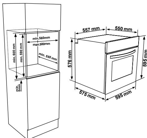
Ak rúru inštalujete pod varič, vzdialenosť medzi pracovným povrhom a horným panelom rúry musí byť minimálne 50 mm a vzdialenosť medzi pracovným povrhom a vrchom ovládacieho panela musí byť minimálne 25 mm.
