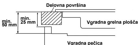
Če je pečica nameščena pod gredno ploščo, mora biti najmanjša razdalja med delovno površino in zgornjo ploščo pečice 50 mm in razdalja med delovno površino in vrhom upravljalne plošče najmanj 25 mm.
