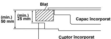
Dacă instalați cuptorul sub o polită, distanța între blatul de lucru și panoul de sus al cuptorului trebuie să fie de minimum 50 de milimetri, iar distanța între blatul de lucru și partea superioară a panoului de control trebuie să fie de minimum 25 de milimetri.
