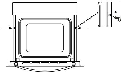
Introduceți cuptorul încorporat în dulap și împingeți-l în față. Deschideți ușa cuptorului și introduceți două șuruburi în găurile amplasate în rama cuptorului. Strângeți șuruburile, când rama produsului atinge suprafața de lemn a dulapului.
