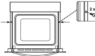
Vložte rúru do skrinky jej zasunutím smerom dopredu. Otvorte dvere rúry a vložte 2 skrutky do otvorov nachádzajúcich sa na ráme rúry. Zariadte, aby sa rám produktu dotýkal dreveného povrchu skrinky, a utiahnite skrutky.
