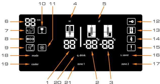
A képernyőn látható értékek a felhasználó által megadott hőmérséklet értékeket jelzik.
