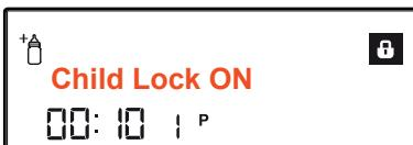
Norėdami išjungti skydelio užraktą, 3 sekundes palaikykite nuspaudę mygtukus į viršų (7) ir į apačią (6). Ekrane bus rodoma, kiek sekundžių laikyti nuspaustus mygtukus „Keep Pressing...X“ (liet. „Laikykite... X“). Pasibaigus rodomam laikui, išjungiamas skydelio užraktas ir ekrane rodomas „Child Lock OFF“ (liet. „Skydelio užraktas išjungtas“) pranešimas, užgėsta (17) indikatorius.
