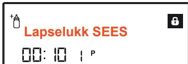
Lapselukku tühistamiseks vajutage samaaegselt 3 sekundi vältel üles (7) ja alla (8) valimise nuppu. Displei annab teile kirjetega "Hoidke veel..X" märku, kui mitu sekundit teil tuleb nuppe all hoida. Kui aeg on möödunud, on lapselukk tühistatud. Displeile kuvatakse kirje "Lapselukk VÄLJAS" ja näidik (17) kustub.
