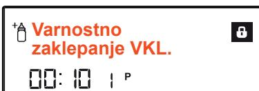
Če želite preklicati varnostno zaklepanje, hkrati pritisnite tipki navzgor (7) in navzdol (6) za 3 sekunde. Zaslon vas bo obveščal, koliko sekund morate še držati gumba s "Pritisnite X". Ko čas poteče, je varnostno zaklepanje preklicano, "Varnostno zaklepanje IZKL." se pojavi na zaslonu in indikator (17) ugasne.
