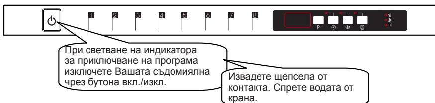
При светване на индикатора за приключване на програма изключете Вашата съдомиялна чрез бутона вкл./изкл.
