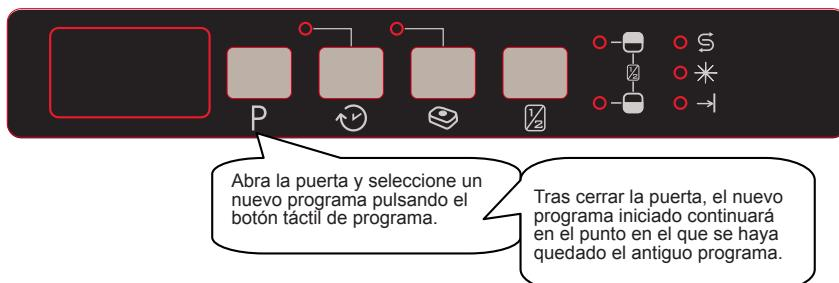
**Nota:** Cuando vaya a abrir la puerta de la máquina para detener el programa de lavado antes de que termine, debe abrir la puerta solo un poco, para evitar que se derrame el agua.
