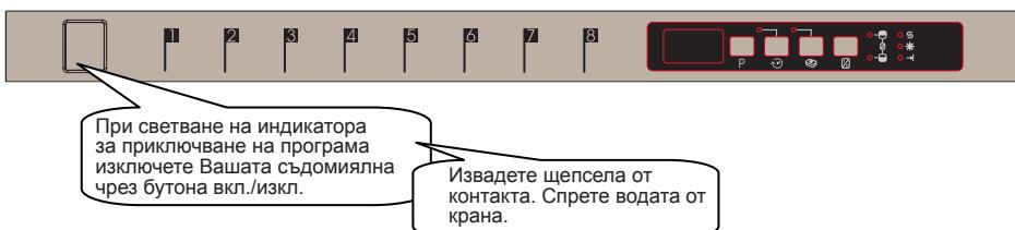
**Забележка:** След звуковия сигнал, обозначаващ приключването на програмата (при светещ светлинен индикатор), оставете вратата на съдомиялната леко откърхната за по-бързо изсъхване.
