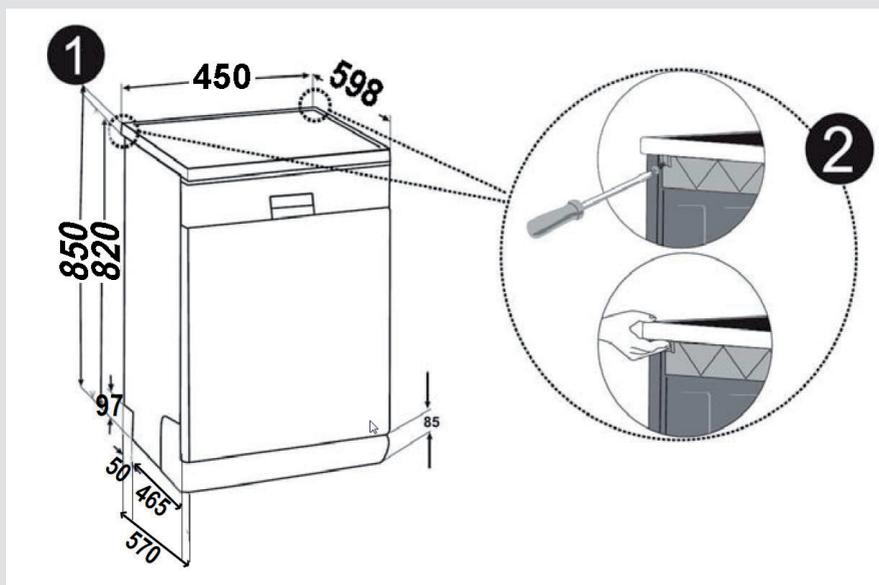
**Advertencia:** La superficie debajo de la cual tiene previsto colocar la máquina tras retirar la tapa superior debe ser estable para evitar desequilibrios. Para retirar la tapa superior, quite los tornillos que la sujetan y que se encuentran en la parte trasera de la máquina. A continuación, empuje el panel delantero 1 cm desde la parte delantera hacia la parte trasera y levante la tapa.
