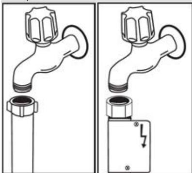
**NOTA:** En algunos modelos se utiliza una salida de agua Aquastop. Si se utiliza Aquastop, se genera una tensión peligrosa. No corte la salida de agua Aquastop. No permita que se doble o tuerza.
