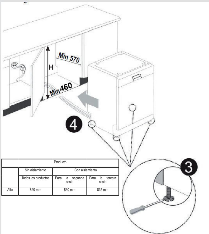
**Advertencia:** Una vez retirada la tapa superior, la máquina debe colocarse en un hueco cuyas dimensiones se indican en la figura.
