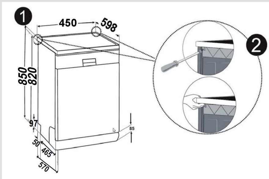
**Atenção:** A superfície sobre a qual está a planear colocar a sua máquina, depois de remover o tampo, tem de ser estável, para evitar balanços. Para remover o tampo, retire os parafusos que seguram o tampo, localizados na parte de trás da máquina. Em seguida, empurre o painel frontal 1 cm do lado da frente em direção ao lado de trás e levante-o.
