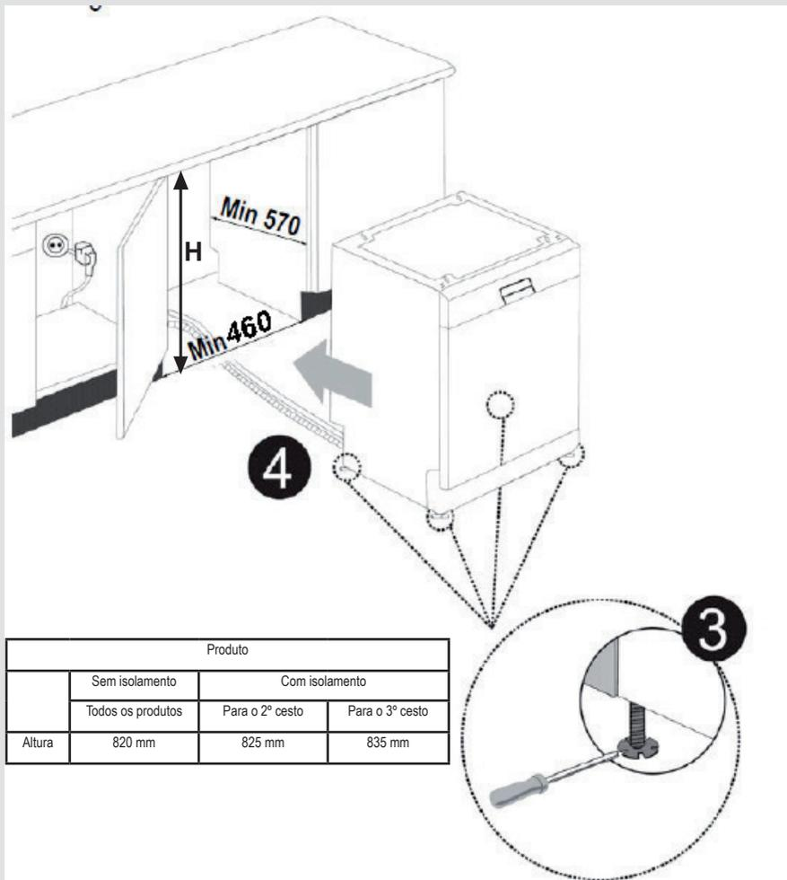
**Atenção:** Depois de retirar o tampo, a máquina deve ser colocada numa cavidade com as dimensões apresentadas na imagem.
